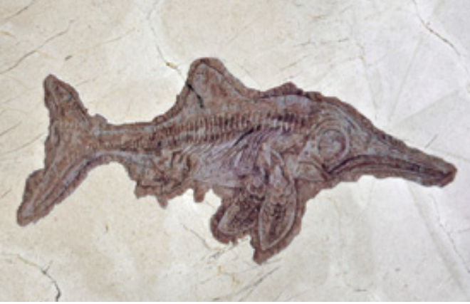
»Anomalie-Entfernung ist keine Einbahnstraße: Dieses »Fossil« wurde mit dem Laser- und Druck-Verfahren von Böhm nachträglich in die Steinoberfläche strukturiert.
